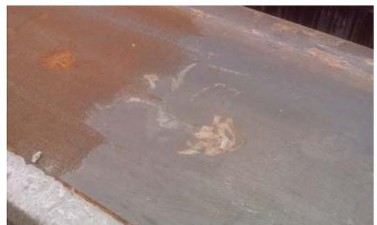
Figura 7.- Diferencia entre una zona tratada con recubrimiento de protección para intemperie en base agua y otra zona no tratada tras dos años de exposición (Zona centro peninsular).
