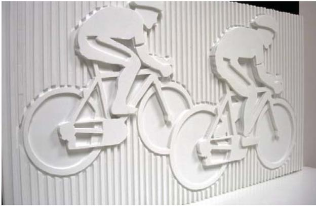
Para la realización de estos murales es necesaria una labor previa de diseño para diseccionar el dibujo original suministrado por el cliente en paneles rectangulares. Cada uno de estos paneles se reproduce en los moldes por medio de recortes de poliestireno extruido. En la Figura 16 puede verse parte del trabajo previo para desglosar un mural que representa una carrera ciclista y un detalle de uno de los paneles.
