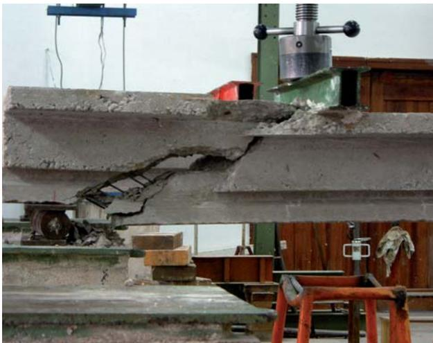
⇒ **Figura 8.-** Ensayos de resistencia a cortante de un forjado unidireccional constituido por vigueta pretensada y hormigón *in situ*.
