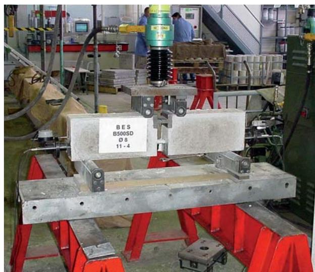
**Figura 2.-** Ensayo de Beam-test.
