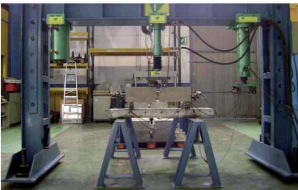
Figura 6.- Ensayo de Beam-Test.
