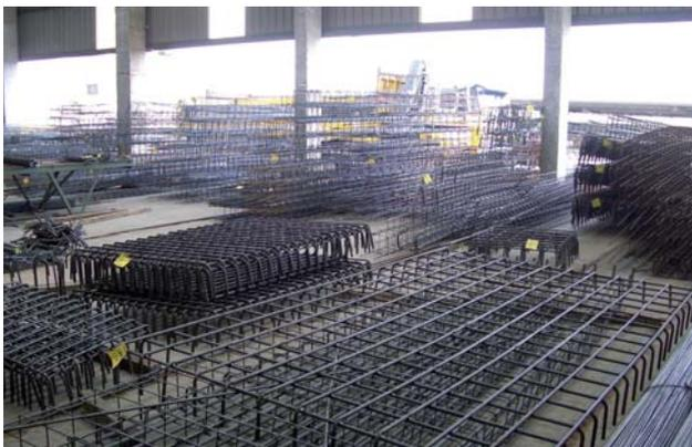
⇒ **Figura 6.-** Ferralla armada en zona de expedición adecuadamente etiquetada y referenciada.
