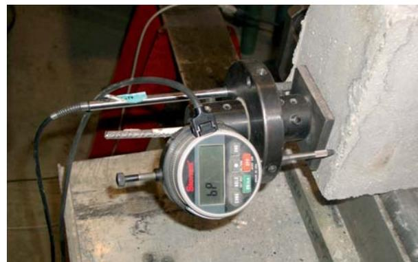
Figura 7.- Instrumento de medida del deslizamiento en uno de los extremos de la barra ensayada.
