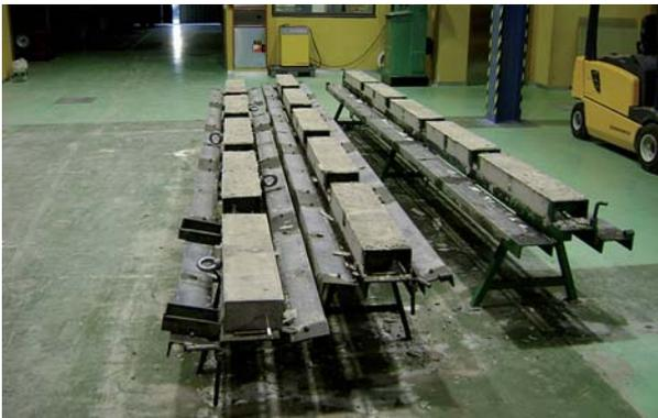
Figura 4.- Desencofrado.
