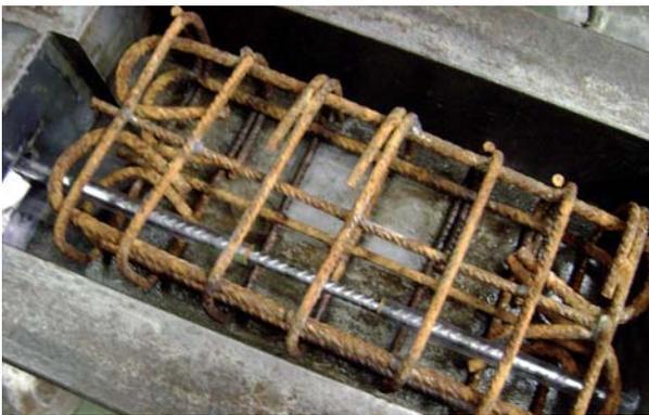
Figura 2.- Disposición de la armadura en una de las semivigas antes de ser hormigonada.
