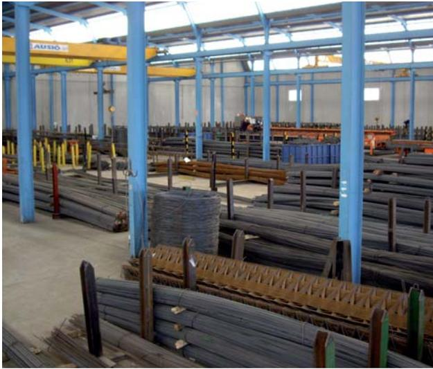
Figura 4.- Área de almacenamiento de una instalación de ferralla.
