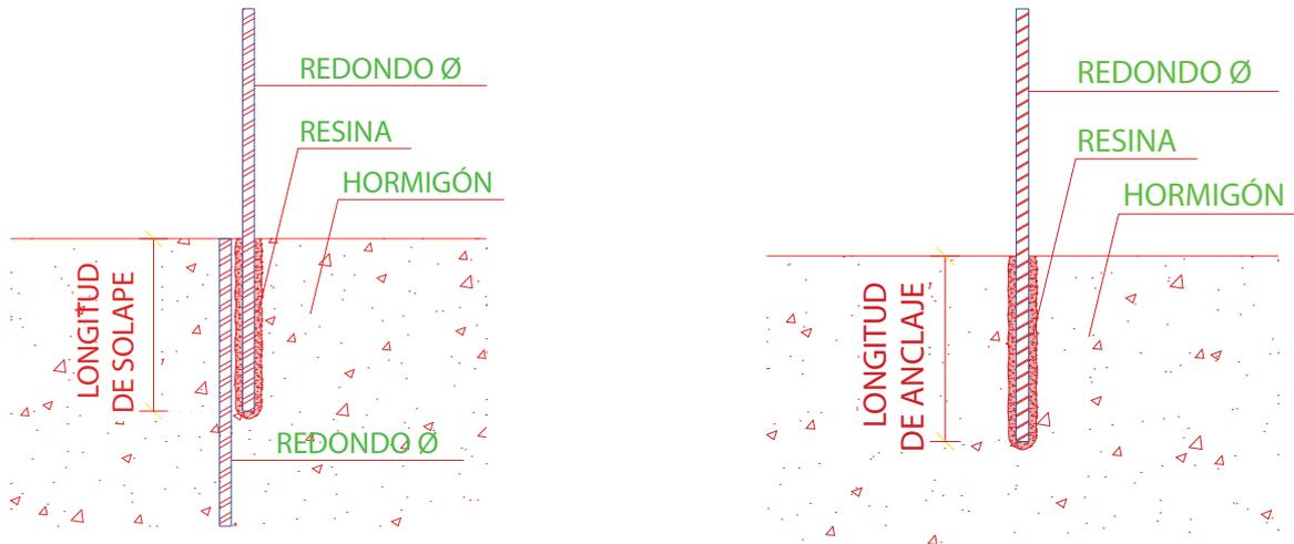
Figura 1.- Solape y anclaje de barras verticales.
