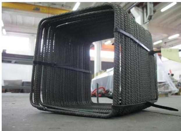
Figura 3.- Estribo continuo en forma de paquete compacto.
