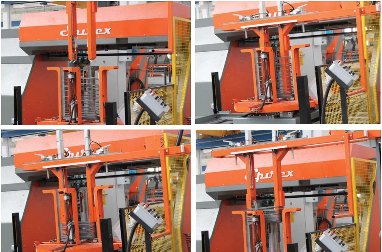
Figura 12.- Operaciones de elaboración, compactación, atado y recogida del estribo continuo.
