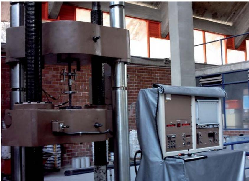
a. Vista general de un ensayo a tracción estático.
